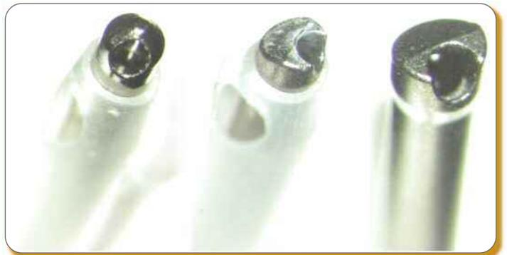
Figure 2 : Extrémité de la sonde laser
