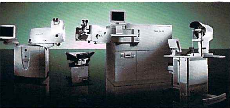
Figure 1. Plateforme AMO. Laser femtoseconde IntraLase ; laser excimer VISX Star S4 IR et aberromètre WaveScan.
